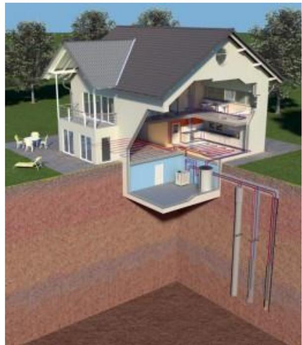
Il calore sarà distribuito in maniera omogenea in ogni punto dell'alloggio grazie ad un sistema radiante a pavimento a bassa temperatura. La contabilizzazione delle spese sarà calcolata in proporzione al consumo grazie all'installazione di conta calorie per le singole utenze, con lettura dalle aree condominiali.
